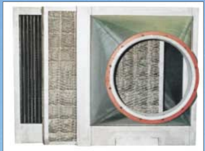
Horizontale Gasströmung: Lamellenabscheider mit Agglomerator
