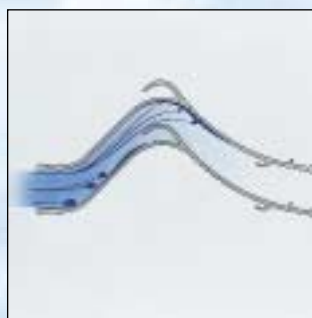
Ablagerung von Tropfen bei horizontaler Anströmung.
